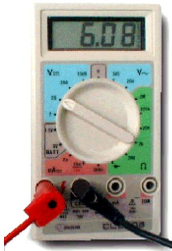
Remarque : Le résultat de la mesure est positif si le très faible courant qui passe dans le voltmètre sort de celui-ci par la borne COM.
