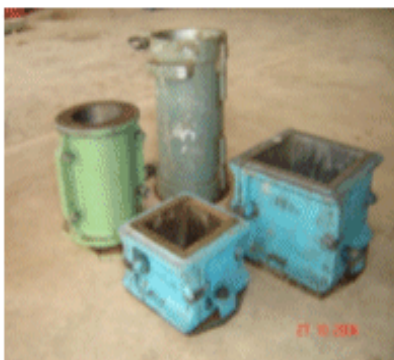
La dimension de l'éprouvette pour mesurer la résistance en compression
